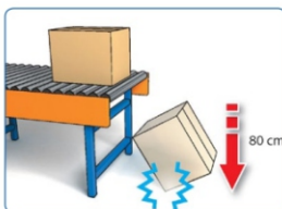
Zkouška obalu nárazem z výšky - při volném pádu do 10 kg 80 cm, nad 10 kg 60 cm (ČSN EN 22248 a 24180-20)
